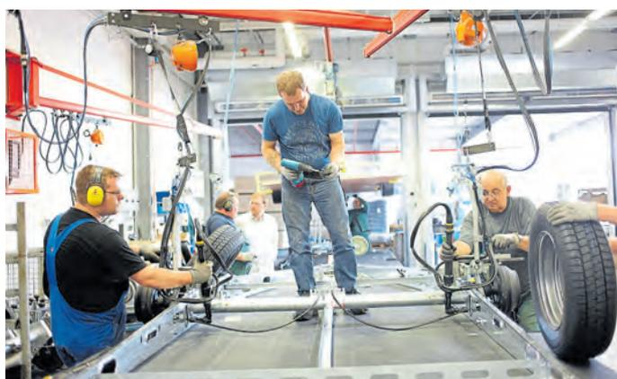
Eine der ersten Stationen in der Montagehalle: Die Achse wird an das eigens produzierte Wohnwagen-Chassis montiert.
