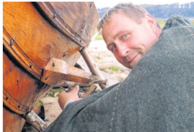
Kai Zausch tüftelt mit alten Techniken. Um Löcher zu bohren benutzt er zum Beispiel einen einfachen Handbohrer.
